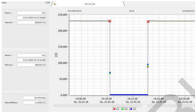
Test 4, Spannung der Außenleiter aufgezeichnet in der [REDACTED] (3. fehlgeschlagene Umschaltung bei Ausfall [REDACTED] und [REDACTED])
