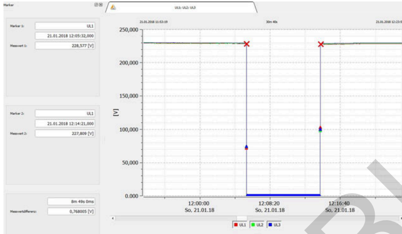
Test 4, Spannung der Außenleiter aufgezeichnet in der [REDACTED] (1. fehlgeschlagene Umschaltung bei Ausfall [REDACTED] und [REDACTED])
